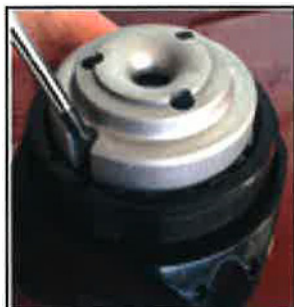
Figure 5 Dévissez le pilote
